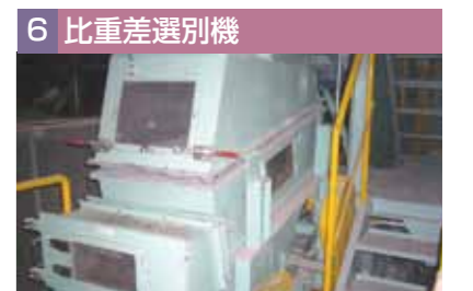
重量物(砂利)と軽量物(木くず・廃プラ類等)の比重差を利用して各々を分離回収します。
