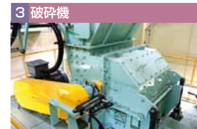
手選残渣は(ハンマー型)破碎機で破碎し粒度を整えます。
