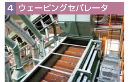
波状に振動する篩いで3種類の粒度に選別し、風力選別の精度を向上させます。
