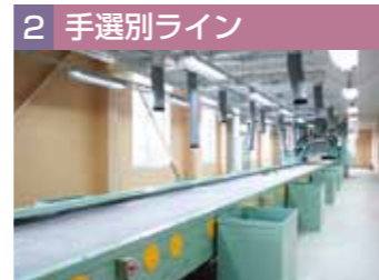
紙くず、軟質プラ、硬質プラ、塩ビ、木くず、繊維くず、非鉄、コンクリートを2次選別します。
