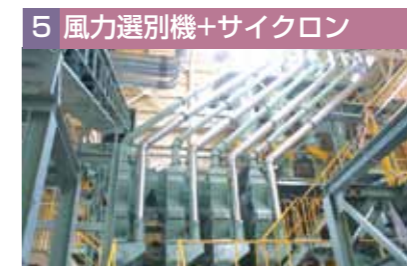
風力選別で軽量物(木くず・廃プラ類等)を搬送気流中から分離回収します。
